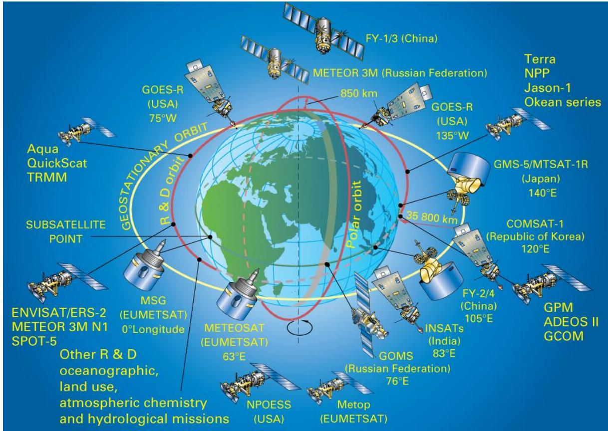
Abb. 6.2: Das globale WMO Satellitenbeobachtungssystem 2009. Die geostationären Satelliten in 36 000 km Höhe und die Satelliten mit polarer Umlaufbahn in ca. 800 km Höhe, dienen der Umwelt- und Klimabeobachtung ([http://www.wmo.int/pages/publications/bulletin\\_en/59\\_1\\_mohren.html](http://www.wmo.int/pages/publications/bulletin_en/59_1_mohren.html))
